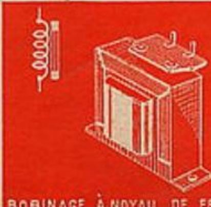
BOBINAGE À NOYAU DE FER
